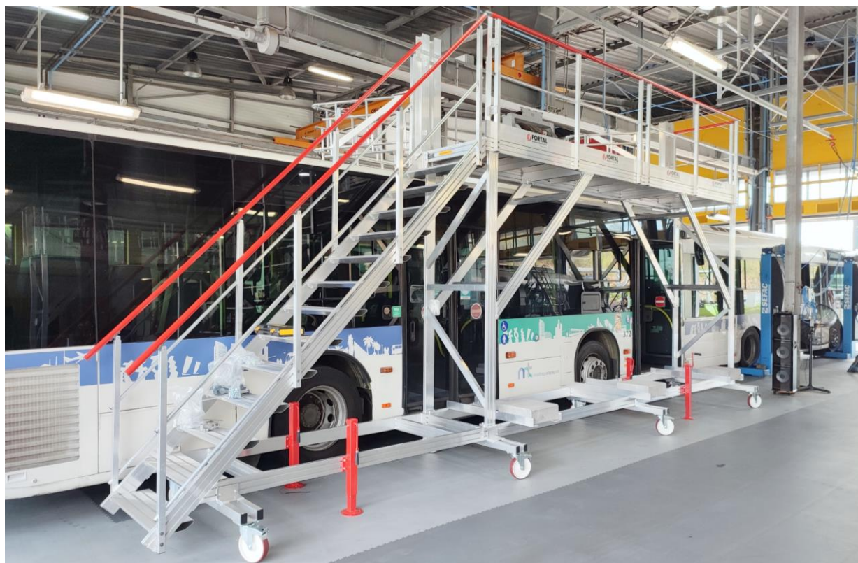
Vue 3D de la plateforme mobile en situation garde-corps articulé déployé
