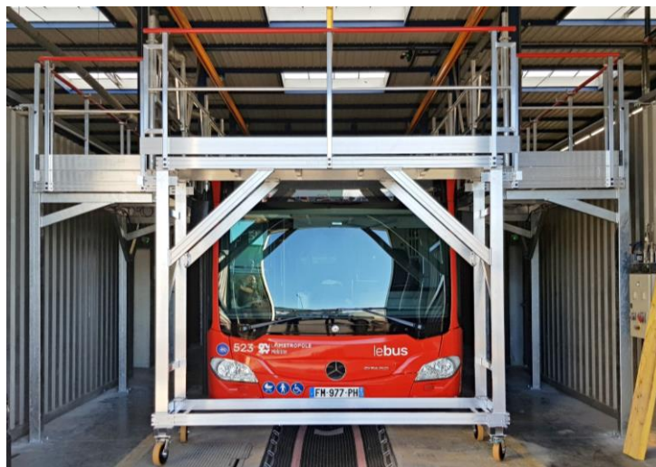
Vue de la plateforme amovible arrière en situation
