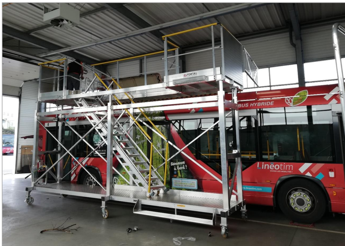
Vue 3D de la passerelle en position haute avec les garde-corps déployés
